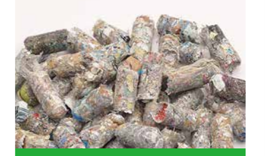
固形燃料(ペレット) 6,000~8,000kcal/kg 長さ 20mm~50mm 直径 10mmの円柱形
